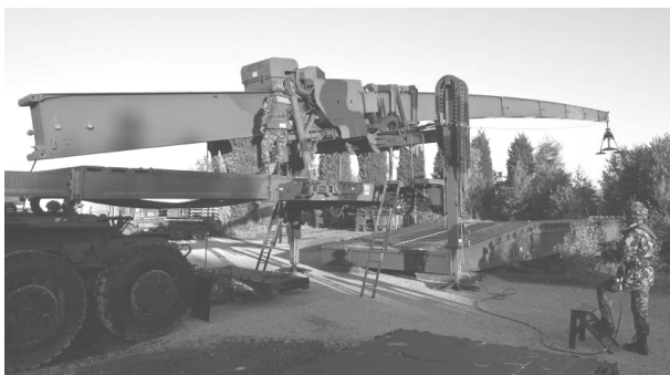
Unité de pose prête au fonctionnement
