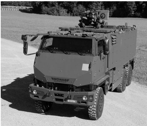
Véhicule protégé de transport de personnes GMTF (DURO III P, 6×6)
