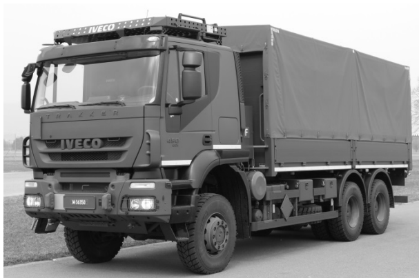
Camion 6×6 à capacité tout-terrain réduite, avec pont couvert et plate-forme de chargement
